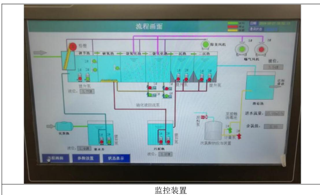
图 4-10 污水自动监控设备工作画面
